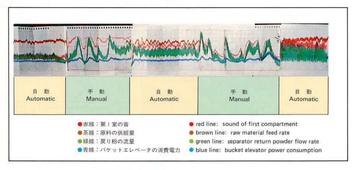
セメント用仕上ミルを、ミルコン SSPFM型により自動運転した場合と、手動運転の場合の結果を示しています。自動運転の場合、バケットエレベータの電力および戻り粉の流量が安定しているのがわかります。
